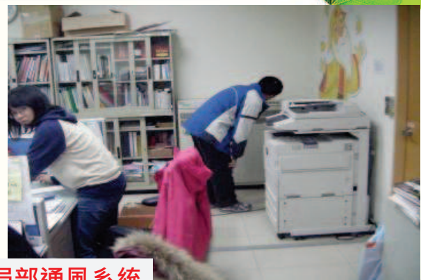
影印機缺乏局部通風系統 且緊鄰員工座位
