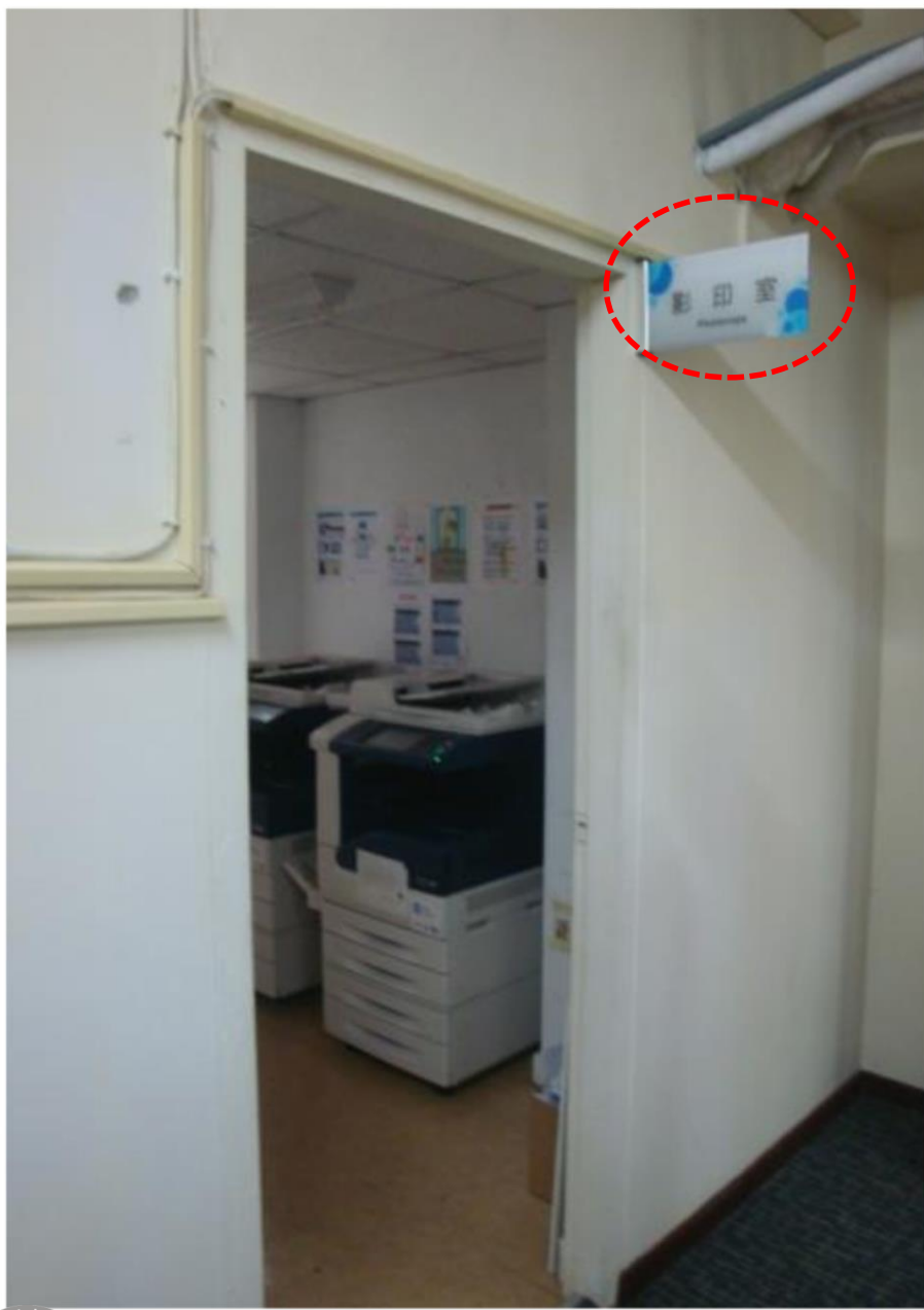
圖8.9 影印機獨立設置或採負壓排氣措施
