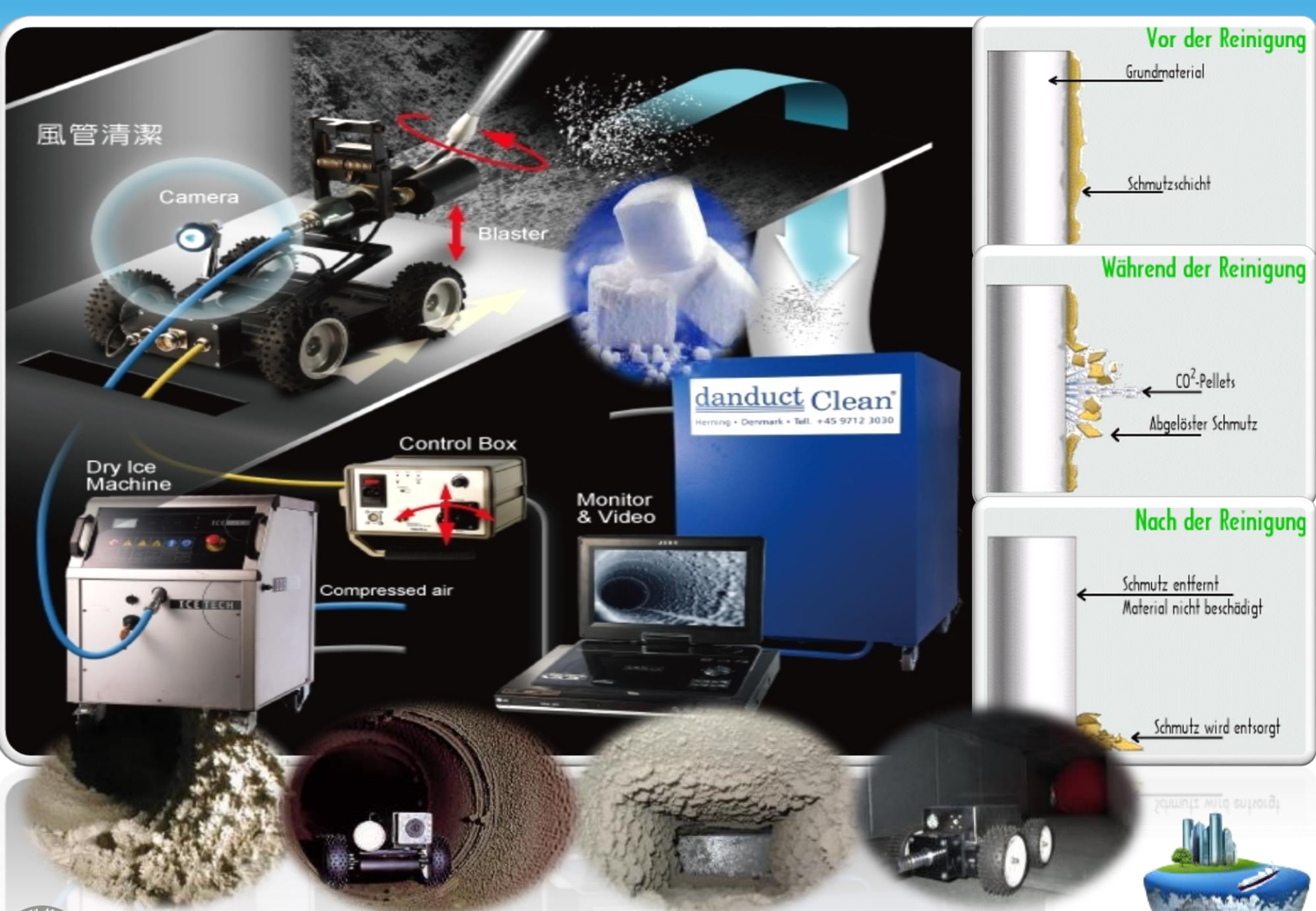
圖6.14 中央空調系統風管內部乾冰清潔技術
