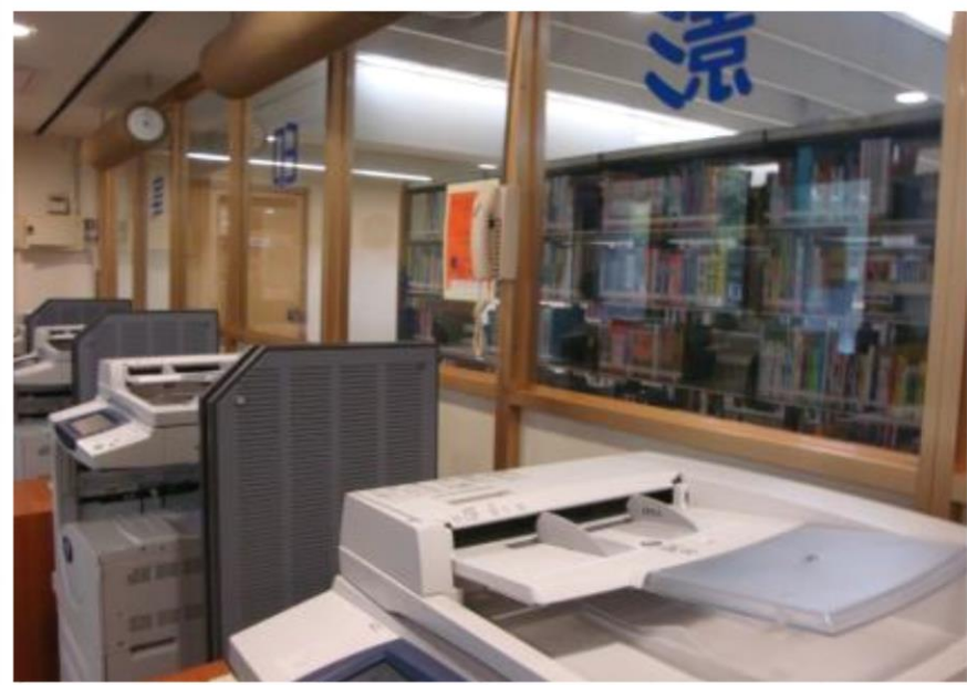
圖8.9 影印機獨立設置或採負壓排氣措施
